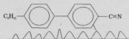
图 2 5CB 分子在电极表面的平躺吸附示意图
