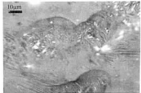
图 5 脉冲激光辐照硅材料熔融区产生的起皱波纹
