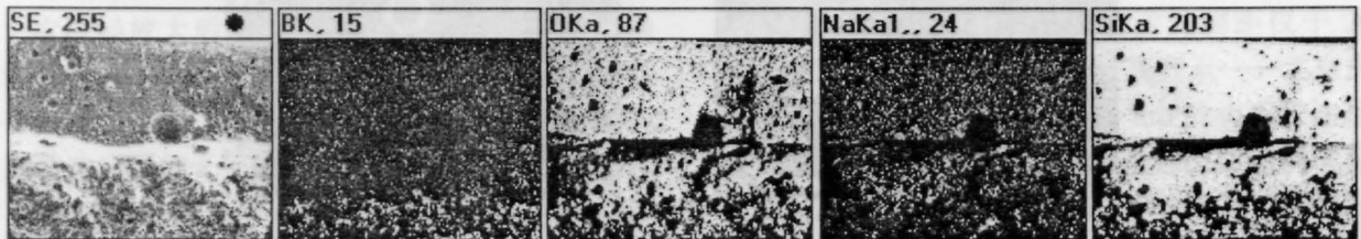
图 3 激光玻璃固化体部分断面的成分分布的电子探针分析
