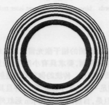
图 2 二元光学校正元件位相等高线图
