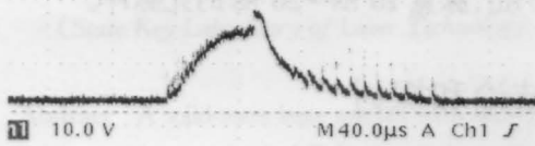
图 4 偏振片侧面出光的光脉冲波形 (KD*P 有 \lambda/4 电压无触发)
