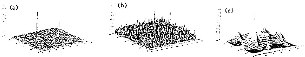
图 5 0.2 个噪声级下 3 种联合变换相关器的输出结果比较
