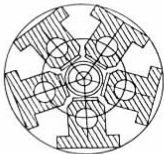
图1 二极管侧面抽运腔的侧视示意图
