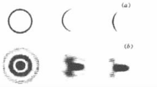
图4 CO 2 共焦非稳腔输出的环模以及由于谐振腔失调引起的模式和它们的远场图样
