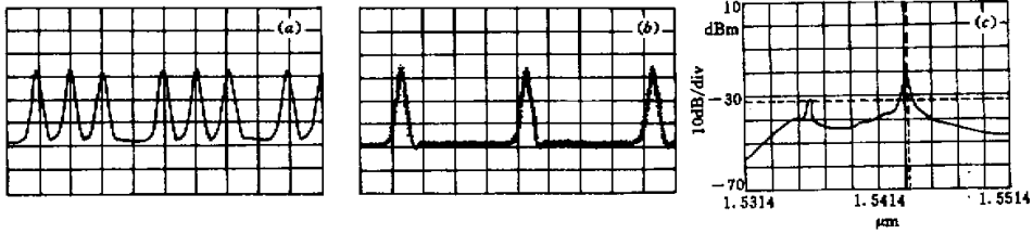
图 4 帧脉冲幅度为 0 的信号波形 (a), 2.5 GHz 时钟提取信号 (b) 及钟信号的光谱 (c)
