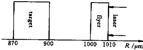
图1 激光直接驱动飞片空腔靶结构示意图
