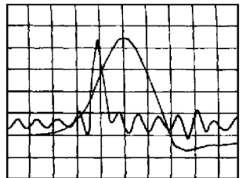
图 1 同时显示的钙离子激光脉冲和其放电激励电流脉冲的波形
