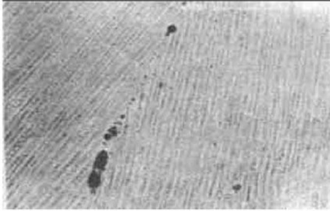
图 6 沿激光熔敷合金层晶界分布的气孔
