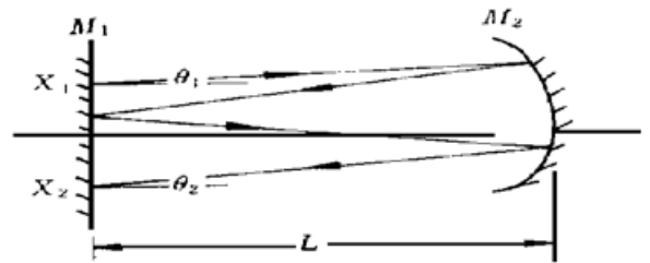
图 1 光线在平-凹镜谐振腔中的传播 Fig. 1 Transmission of light in the plano-concave resonator
