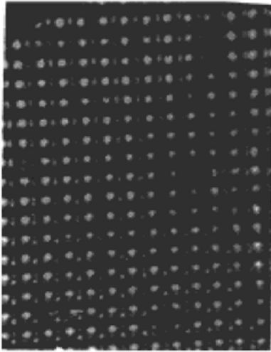
图 3 四个球面波产生的干涉显微照片 Fig. 3 Micrograph of the interference due to four spherical waves
