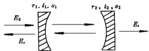
图 1 等效简单谐振腔示意图
