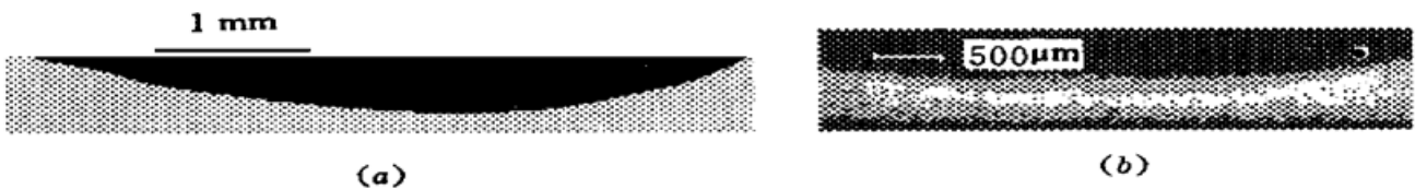
图 7 实际激光束淬火带的理论模拟 (a) 与实验测量结果(b) 的比较
