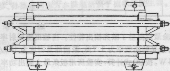
图 4 玻璃板条器件结构
