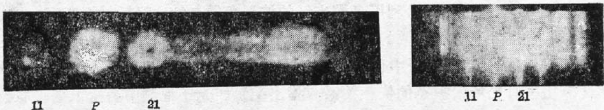
图 4 一级 anti-Stokes 谱上一对频移不同、瓣向分别为水平和垂直的 LP_{11} 模
