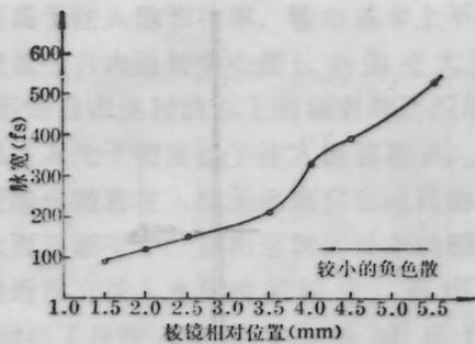
图4 喷流位置固定时,脉宽随色散变化的关系曲线
