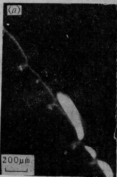
(a) 裂隙产生在由直线位错攀移成蜷线的初始部位
