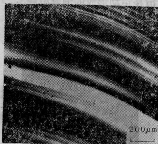
图 10 正交偏光下, 生长条纹的不均匀所引起的应力双折射效应
