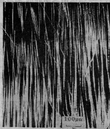
图7 晶体生长近结束部份所出现的大量非级饰为位错及折线状混合型位错 (激光光散射层貌照片)
