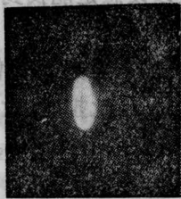
图8 扁平激光器的输出光斑
