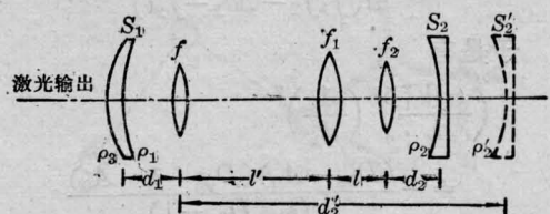
图 1 具有一个内热透镜的望远镜谐振腔
