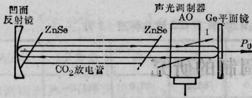
图1 腔内光循环方式示意
