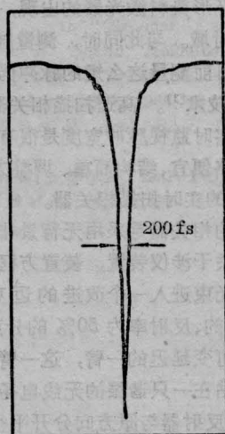
图 3 实时快扫描相关器和慢扫描相关器测试的相关曲线的比较
