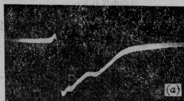
图2 没有连接 LC 脉冲形成线时的光脉冲波形 时标 10 ns/div
