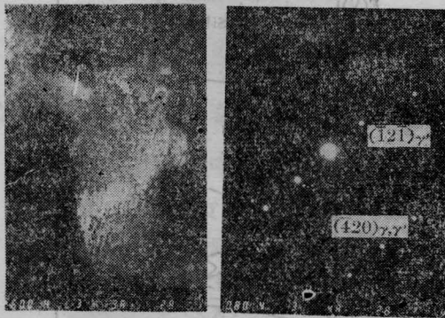
图7 \gamma -NiCr 固溶体中弥散析出的 \gamma' -Ni 3 Si 粒子的透射电镜形貌(a)及其电子衍射图案(b)
