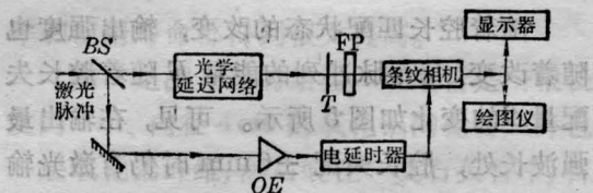
图 3 BWS-5K 型条纹相机测量激光脉冲宽度光路图
