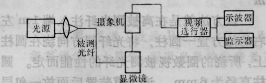
图3 显微近场分析法实验系统
