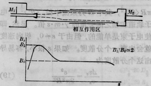
图 1 具有轴向磁场的自由电子激光振荡器的实验方案及轴向磁场沿纵向的分布
