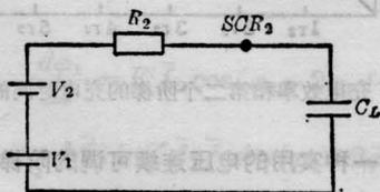
图3  $SCR_2$  触发导通后的充电回路
