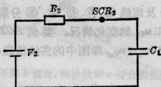
图4 关断回路
