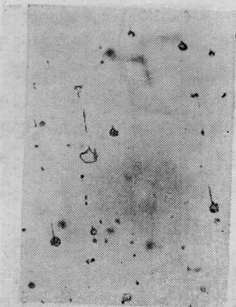
图6  $\alpha$ 轴晶体(010)试样夹杂物
