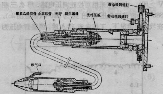
图2 光纤光缆耦合器的结构
