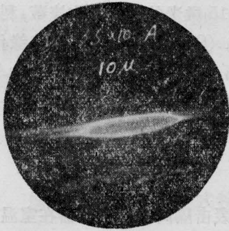
图3 用红外透射/发光法观测的 D_2^+ 轰击激光器近场发光图样
