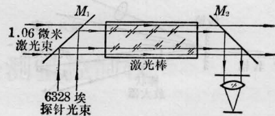
图3 产生扭动光束的光路
