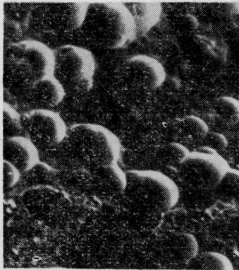
图3 氟磷玻璃中的“滴”状夹杂物 (SEM×1000)
