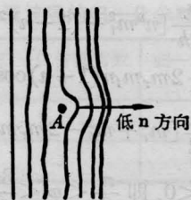
图3 A点局部加热时的干涉条纹变化
