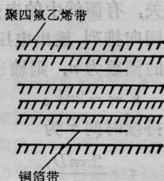
图 4 TIV 号发生器传输线剖面示意图
