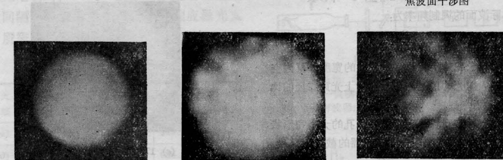
图 4 波面剪切干涉图与滤波后的光强分布(滤波小孔为 200 微米)
