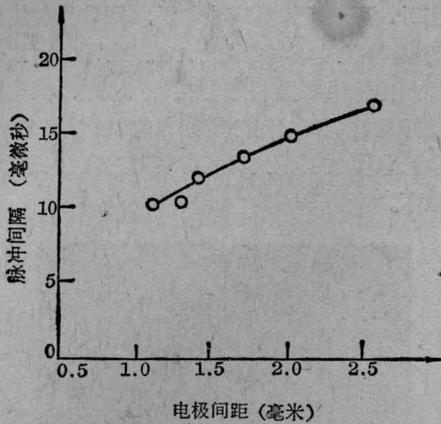
图3 脉冲间隔与电极间距关系曲线
