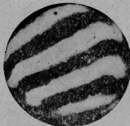
图6 抛物面镜的干涉检验图
