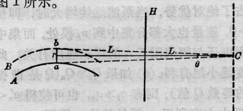
图1 轮胎上任意点 a 在载荷作用下变至 b 点,它们所反射的光波在 c 处发生干涉
