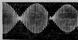
照片2 1000赫+50赫调制光信号(横标为2毫秒/格, 纵标为5伏/格)
