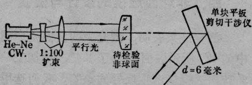
图5 非球面镜检验光路
