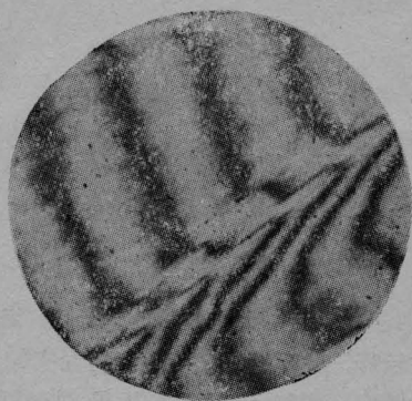
图3 用高速摄影机摄得的斜激波的干涉图案
