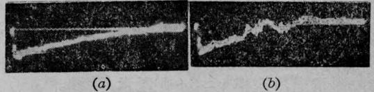
图7 真空度为  $2.5 \times 10^{-5}$  托 (a) 和  $8.5 \times 10^{-5}$  托 (b) 时的枪电压波形 (阻容分压器测量)
