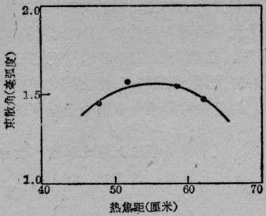
图2 多模束散角随热焦距的变化
