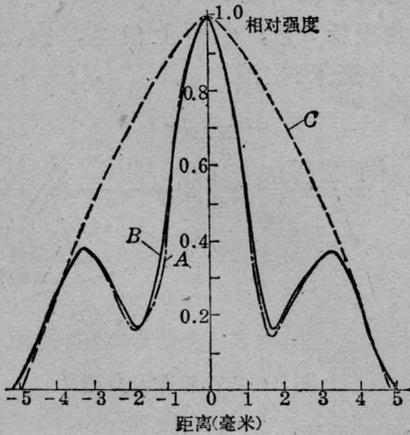
图 6 双孔衍射场分布经圆孔光栅衰减器后的场分布(显微密度计测量)
