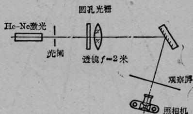
图3 实验装置示意图
