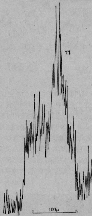
图5 纤维中 Tl + 的电子探针分析谱线 (样品: 7605#-6)
