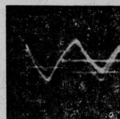
图 3 远红外激光输出的示波照片
