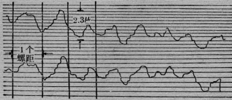
图5 机床部分周期误差重复测量曲线 定标: 0.23 微米/格 (1.6 毫米)
